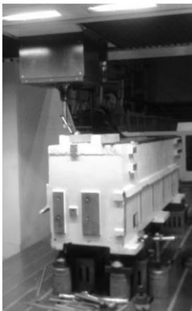
*Рисунок 5. Выверка станины на станке*
