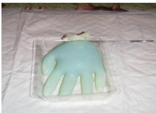
***Рисунок 7. Макет с искусственной средой и исследуемым предметом помещается в контейнер для сканирования***
