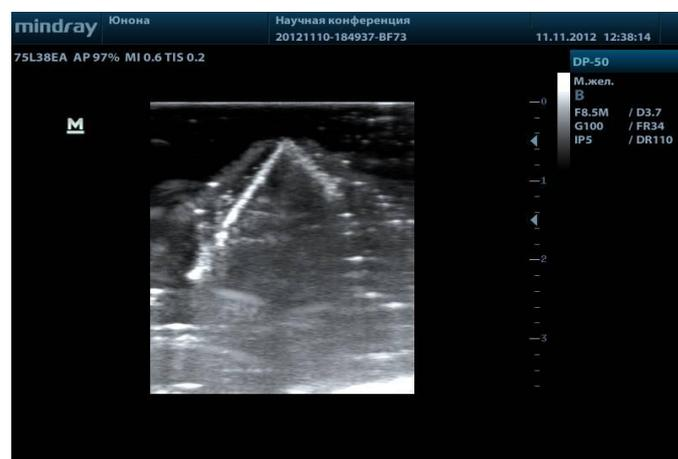
*Рисунок 22. Кусок моркови в форме треугольника на снимке изображен остроугольным в виде светящейся полосы*
