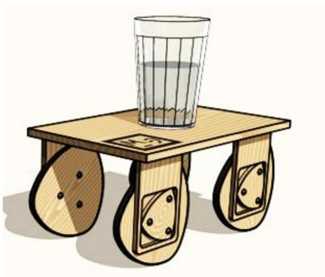
*Рисунок 5. Повозка с подвеской на основе треугольника Рело*
