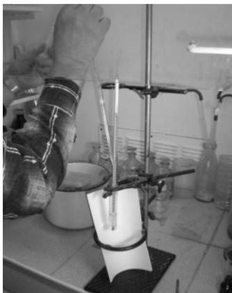
***Рисунок 8.2. Вид реакционной смеси (водный раствор ДМГФ) перед началом димеризации ДМГФ***
