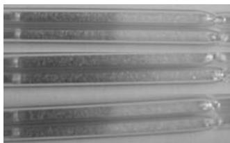
**Рисунок 7.7. Длина отработанного слоя на реактивных растворах: 0,1 % селенистая кислота (верхняя пара ИТ); 0,01 % азотнокислое серебро (средняя пара ИТ); смесь (1:1) обоих реактивных растворов**
