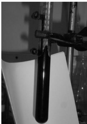
***Рисунок 8.7 Результат нейтрализации НДМГ формалином и уксусной кислотой***
