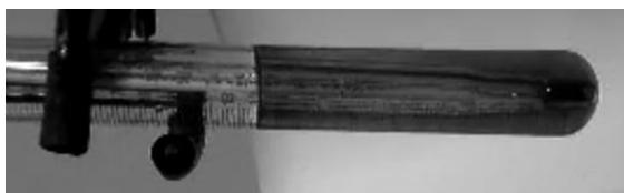
***Рисунок 8.4. Образование красно-коричневых полимеров на начальной стадии***
