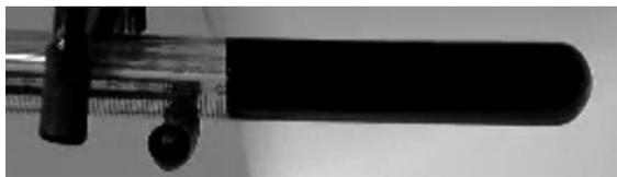
***Рисунок 8.5. Интенсивное образование полимеров***
