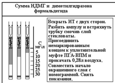
**Рисунок 7.10. Общий вид шкалы для индикаторной трубки на сумму НДМГ и ДМГФ**
