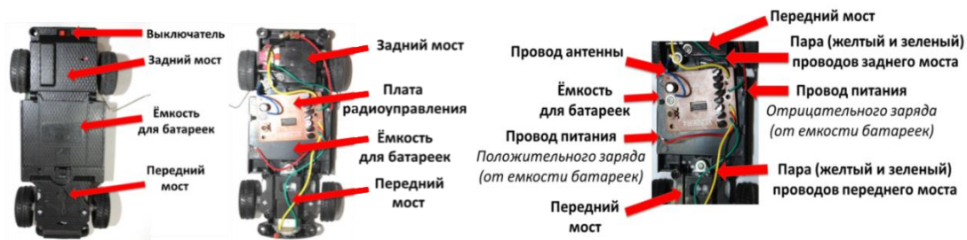
Рисунок 1. Структура радиоуправляемой платформы и радиоуправляемой платы
