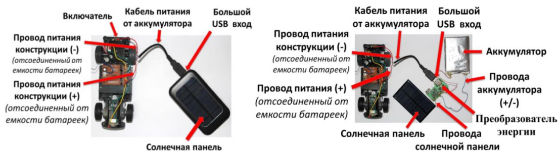
Рисунок 4. Схема соединения солнечной панели с платой радиоуправления
