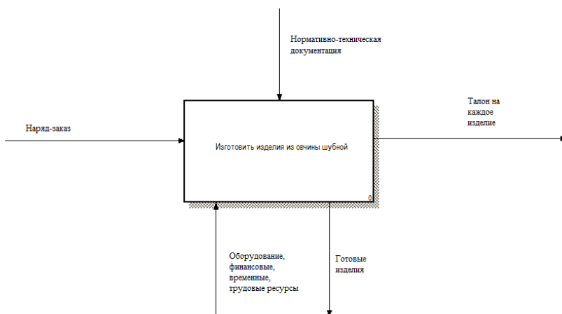
Рисунок 1. Модель процесса производства изделий из овчины шубной
