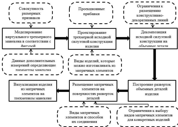
Рисунок 1. Модель функционирования процесса проектирования изделий из матричных элементов в трехмерном пространстве
