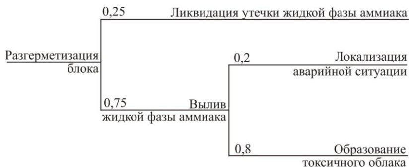
Рисунок 4. Дерево событий при авариях в технологическом блоке слива жидкого аммиака
