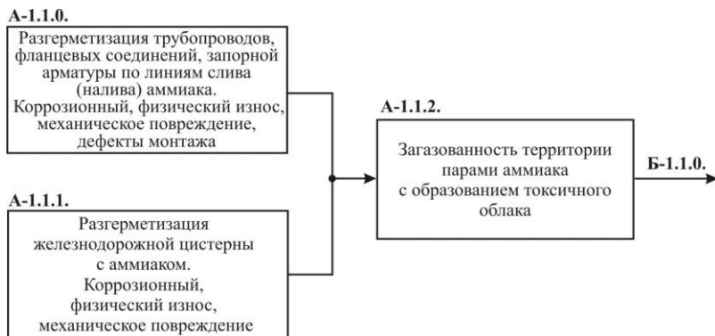
Рисунок 1. Схема сценариев развития аварийных ситуаций в блоке слива жидкого аммиака цеха ПГЭ
