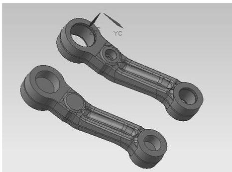
*Рисунок 1. Модели детали и заготовки в файле сборки*
