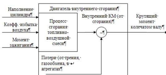
**Рисунок 1. Схема определения крутящего момента с использованием математической модели**
