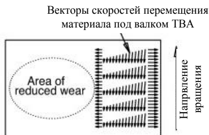
Рисунок 2. Характер движения материала под валком
