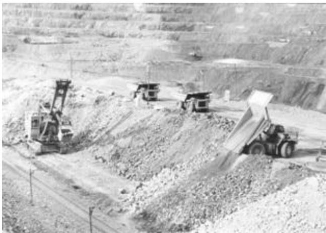
**Рисунок 4. Перегрузочно-усреднительный склад железной руды в карьерах Северного Казахстана**
