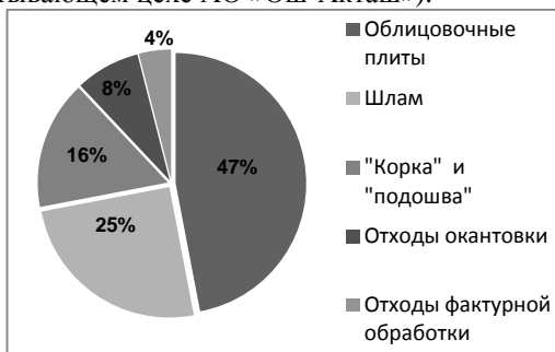
Рис. 1. Структура распределения отходов при распиловке блоков известняка-ракушечника
