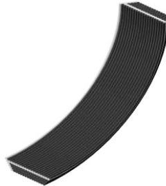
Рисунок 1. Фрагмент геометрической модели намотки нитей на сновальном валике
