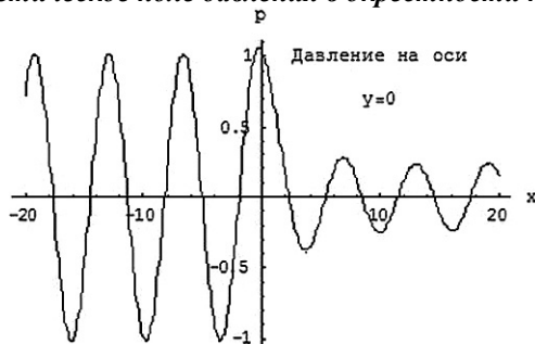
Рис. 9. Распределение давления (плотности) на оси канала.
