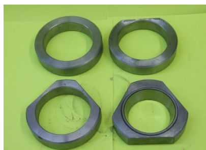
Рисунок 4. Образцы моделей корпусных элементов с неравномерной окружной жесткостью для запрессовки наружных колец подшипников с гарантированным радиальным натягом в соответствии с техническими условиями предусмотренными посадками на сборку неподвижных соединений в редукторе
