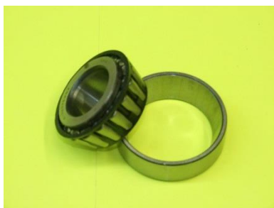
Рисунок 3. Конический роликоподшипник 7807 с углом наклона поверхности качения наружного кольца \beta = 20 град, внутреннее кольцо с роликами в пласт.массовом сепараторе
