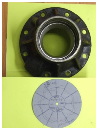
Рисунок 14. Круглограмма поверхности качения наружного кольца подшипника после запрессовки в реальный корпус с ребрами жесткости и масляными каналами
