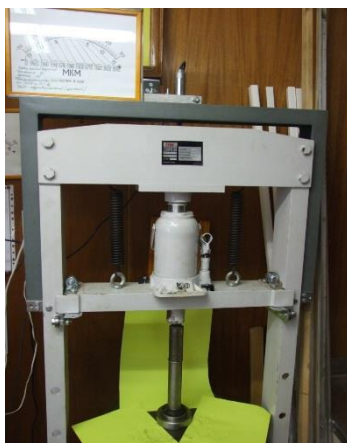
Рисунок 5. Пресс гидравлически для выполнения прессовых неподвижных соединений – «наружное кольцо – корпус» с контролем действительной силы запрессовки по длине контакта с помощью индуктивной измерительной системы
