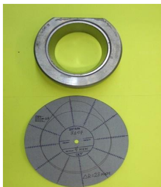
Рисунок 10. Круглограмма поверхности качения наружного кольца подшипника после запрессовки в модель корпуса с односторонним элементом снижения радиальной жесткости
