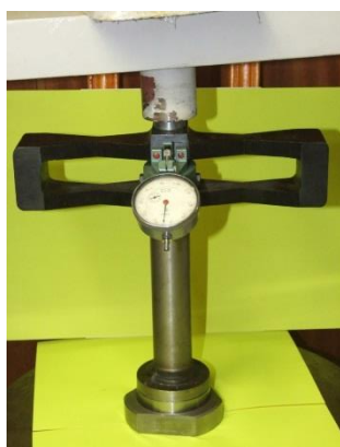
Рисунок 6. Тарировка индуктивного датчика для контроля силы запрессовки с помощью динамометра сжатия ДОСМ – 5 тс
