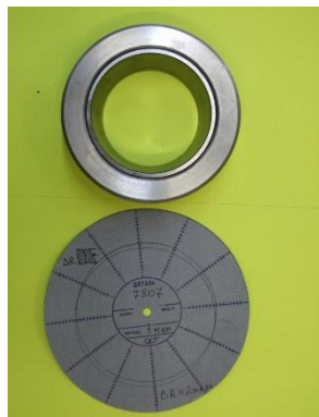
Рисунок 9. Круглограмма поверхности качения наружного кольца подшипника после запрессовки в модель корпуса с равномерной радиальной жесткостью. Отклонение от круглости не превышает 2 мкм
