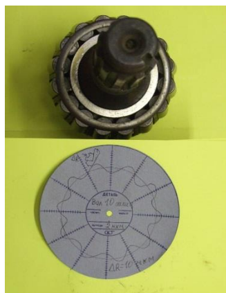
Рисунок 23. Круглограмма поверхности качения внутреннего кольца подшипника после запрессовки на цилиндрическую поверхность шлицевого вала
