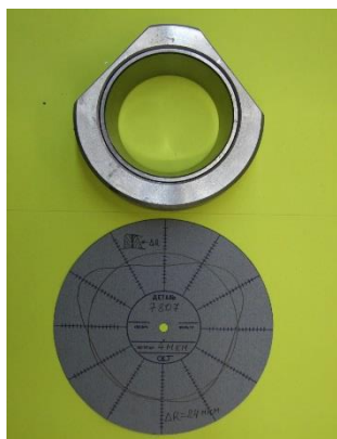
Рисунок 11. Круглограмма поверхности качения наружного кольца подшипника после запрессовки в модель корпуса с двумя элементами снижения радиальной жесткости
