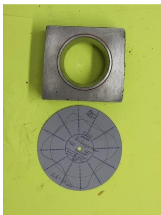
Рисунок 13. Круглограмма поверхности качения наружного кольца подшипника после запрессовки в отверстие модели корпуса с четырехгранной формой наружной поверхности
