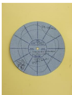
Рисунок 20. Круглограмма поверхности качения наружного кольца подшипника при запрессовке с перекосом в процессе выполнения прессового соединения
