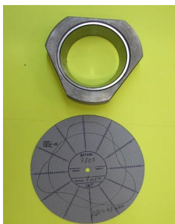
Рисунок 12. Круглограмма поверхности качения наружного кольца подшипника после запрессовки в отверстие модели корпуса с тремя элементами снижения радиальной жесткости
