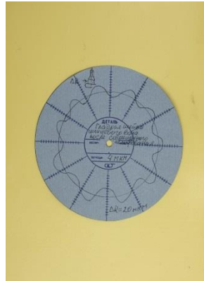
Рисунок 22. Круглограмма поверхности цилиндрической шейки шлицевого вала после совмещенного шлифования на одном станке
