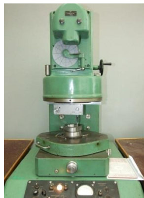
Рисунок 7. Кругломер «Калибр 218» для исследования точности формы поверхностей качения наружных колец подшипников после запрессовки в модели корпусов
