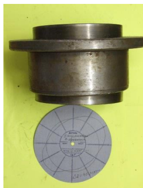
Рисунок 19. Круглограмма поверхности качения наружного кольца подшипника, установленного в корпус с равномерной жесткостью но с перекосом относительно оси вращения
