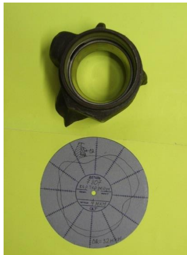
Рисунок 16. Круглограмма поверхности качения наружного кольца подшипника после запрессовки в горловину картера редуктора двумя ребрами жесткости и масляным каналом, исключаяющим контакт поверхности кольца с корпусом
