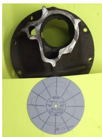
Рисунок 15. Круглограмма поверхности качения наружного кольца подшипника после запрессовки в картер редуктора с несимметричными ребрами жесткости и масляными каналами
