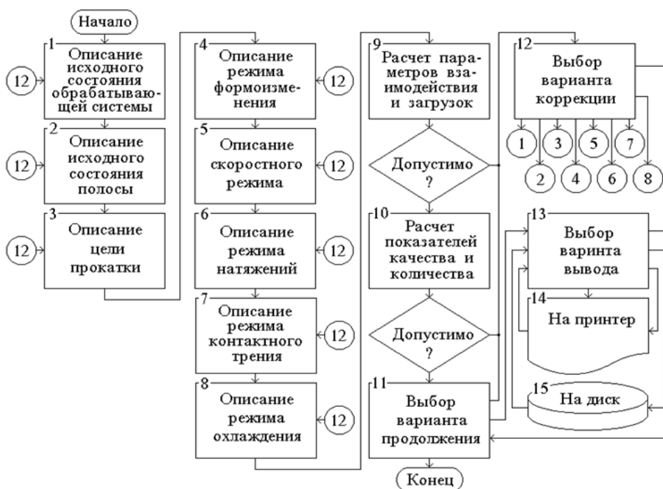
Рисунок 2. Обобщенный алгоритм автоматизированного проектирования режимов прокатки
