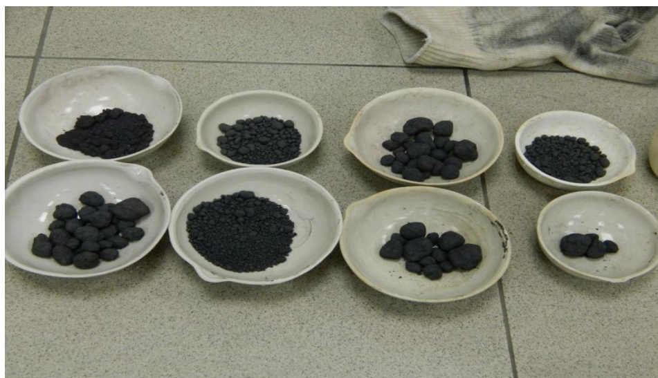
Рисунок 2. Полученные окатыши для различных содержаний бентонита
