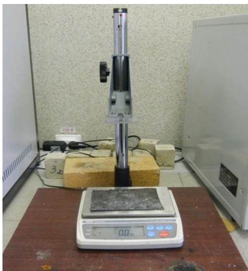
Рисунок 3. Лабораторная установка для определения прочности сырых окатышей
