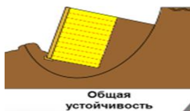
Рисунок 3. Механизм ползучести грунта сооружения
