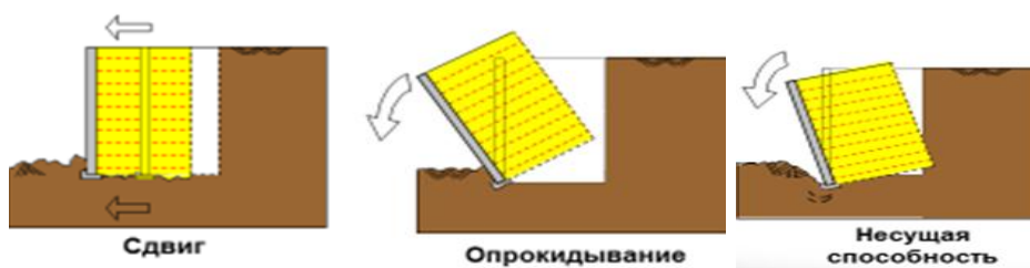
Рисунок 2. Механизмы разрушения армогрунтового сооружения
