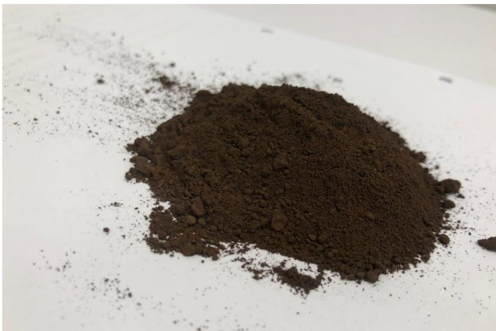
*Рисунок 2. Внешний вид пыли газоочистки дуговой электросталеплавильной печи*
