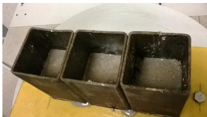
Рисунок 4. Изложницы со смесью после формования
