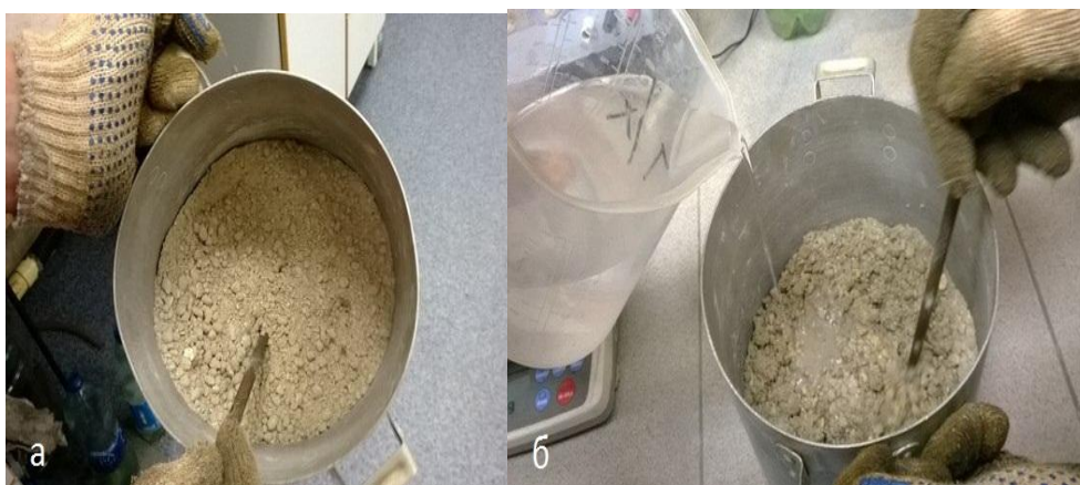
Рисунок 2. Получение огнеупорной смеси: а) сухое перемешивание; б) добавление воды
