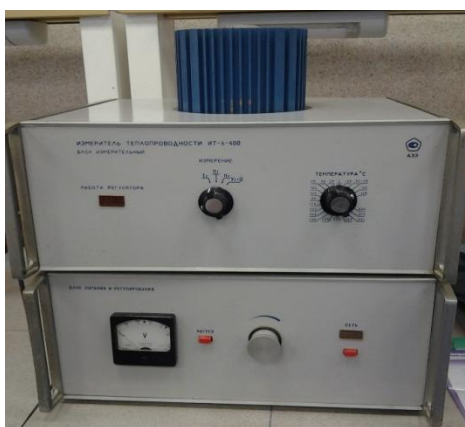
Рисунок 2. Прибор для измерения теплопроводности ИТ- \lambda -400
