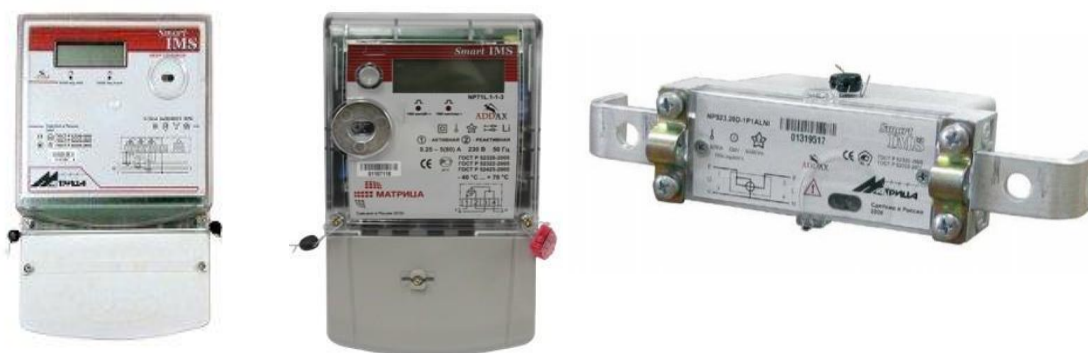
Рисунок 1. Внешний вид однофазных электросчётчиков Матрица слева направо: NP515 ,NP71L.1-1-3,NP523
