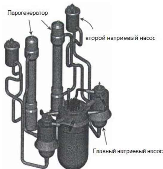
Рисунок 1. Реактор на быстрых нейтронах петельного типа с натриевым теплоносителем ( N_{т}=3530 МВт, N_{э}=1500 МВт)
