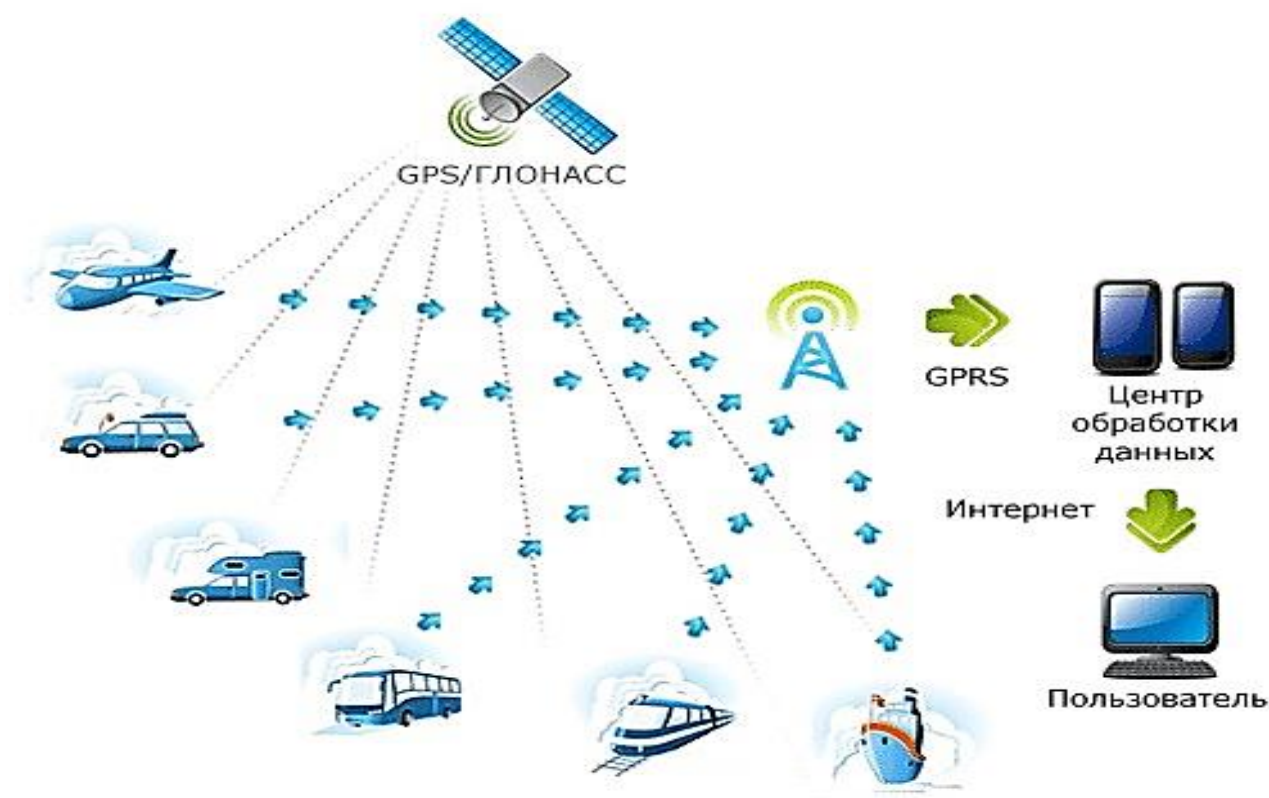
Рисунок 1. Система спутникового мониторинга транспортных средств с помощью GPS/ГЛОНАСС
