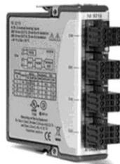
**Рисунок 5. Преобразователь аналого-цифровой многоканальный NI 9219**
