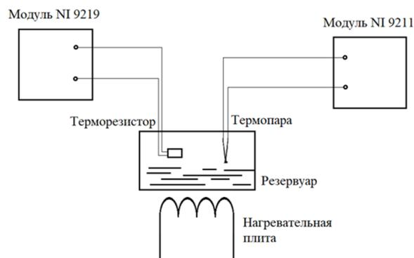
**Рисунок 7. Схема экспериментального стенда**
