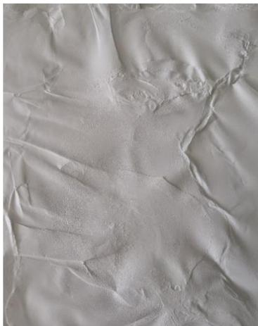
**Рисунок 2. Вид мембраны ВВ3-30 (концентрация ПВХ 3 масс. %, концентрация H<sub>2</sub>O 0,68 масс. %, время выдержки на воздухе 30 с)**
