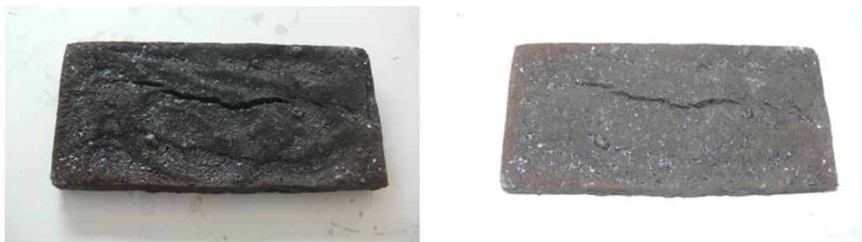
**Рисунок 1. Полученные образцы пеностекла**
