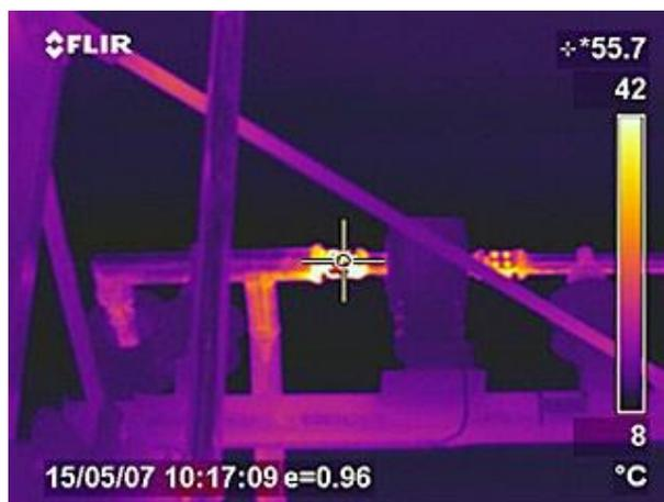
*Рисунок 3. Перегрев (+55°C), контактного соединения на подстанции*
