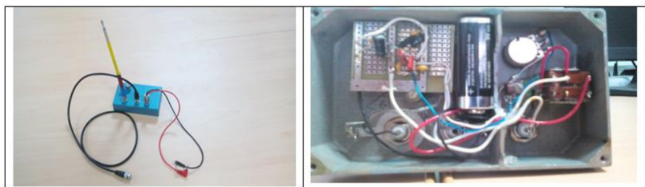
Рисунок 4. Внешний вид индикатора поля
