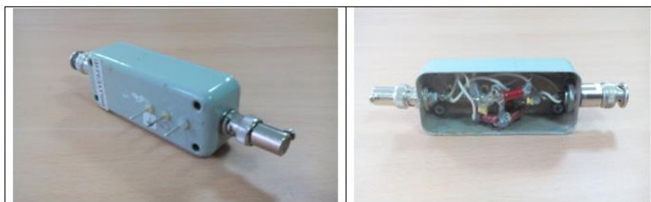
Рисунок 2. Внешний вид КСВ-метра
