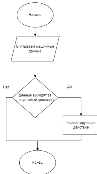
Рисунок 1. Процедура постоянного мониторинга износа твердосплавного режущего инструмента
