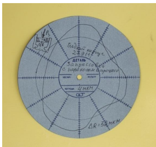
Рисунок 10. Круглограмма поверхностей качения наружных колец конических роликоподшипников записанных в процессе исследования влияния отклонения от круглости на осевую податливость
