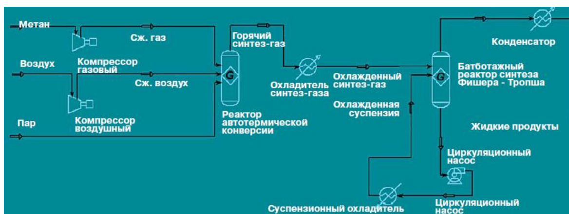
Рисунок 2. Технологическая схема опытно-лабораторной установки применения GTL-технологии [10]
