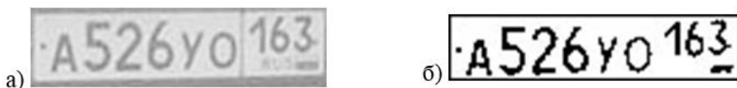
Рисунок 3. Преобразование изображения в набор биполярных сигналов: а — нормализация изображения путем трансформации до фиксированных размеров; б — приведение изображения в двухцветный вид без использования градиентов серого
