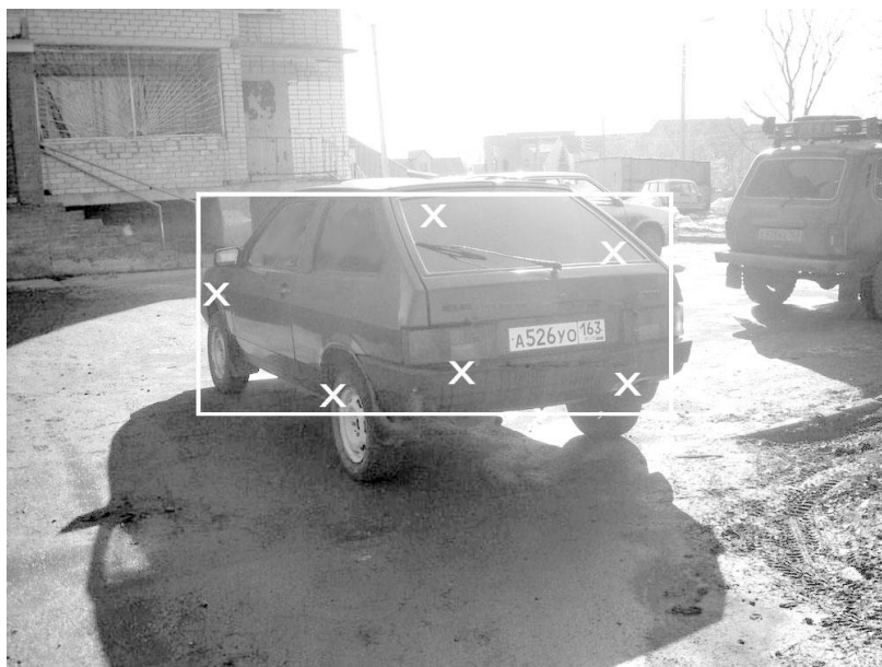
Рисунок 1. Результат выделения движущегося объекта с помощью алгоритма k-means. Крестами показаны центры кластеров. Рамкой показано объединение ближайших кластеров
