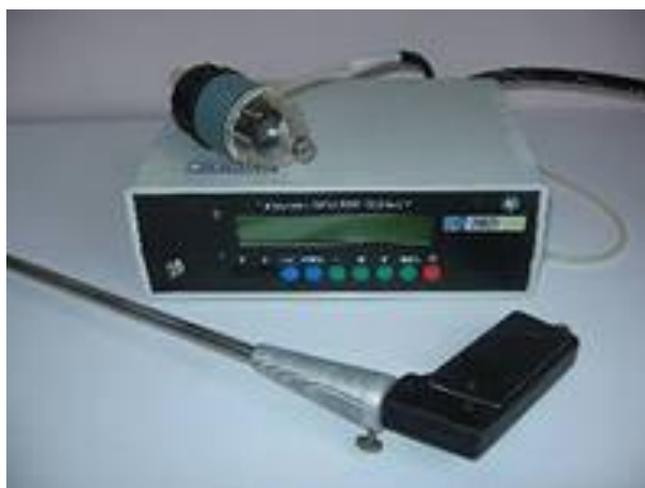
***Рисунок. 2 Газоанализатор ПЭМ 4М***
