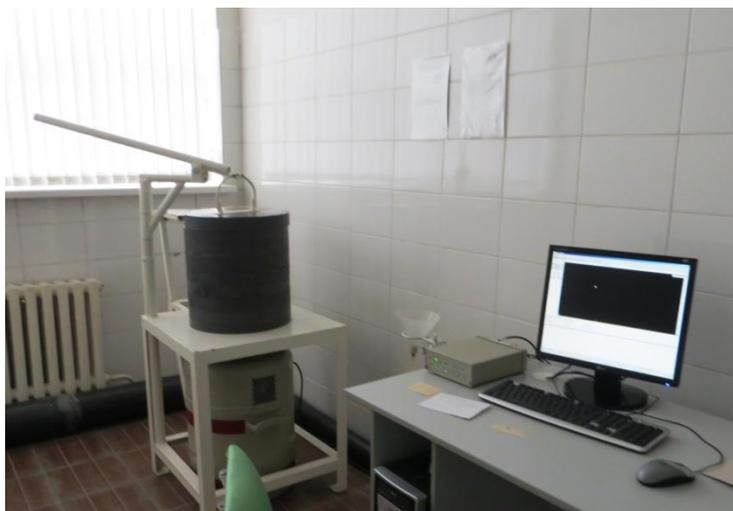
***Рисунок 4. Гамма-спектрометр с электроохлаждаемым детектором GC2019 и цифровым многоканальным анализатором DSA-1000***
