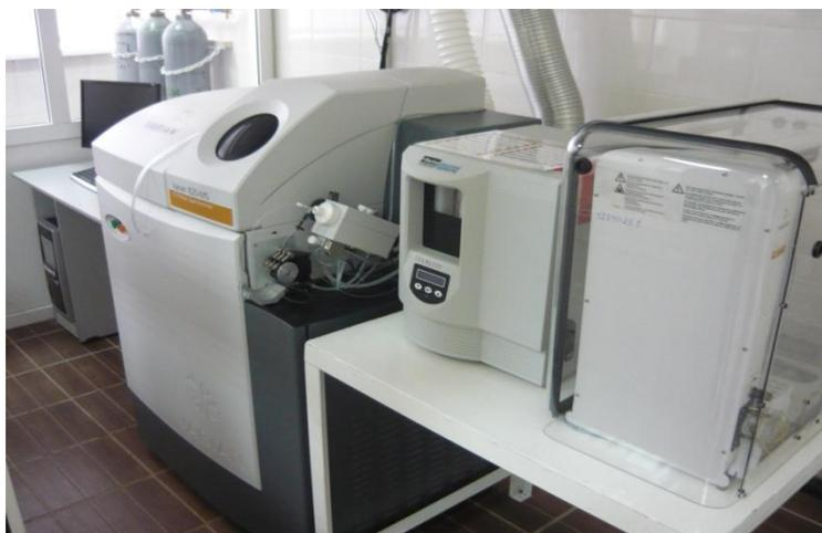
**Рисунок 5. Спектрометр индуктивно-связанной плазмы Varian 820 ICP-MS**
