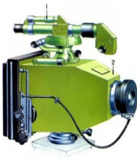
Рисунок 1. Фототеодолит: 1 – теодолит, 2 – фотокамера
