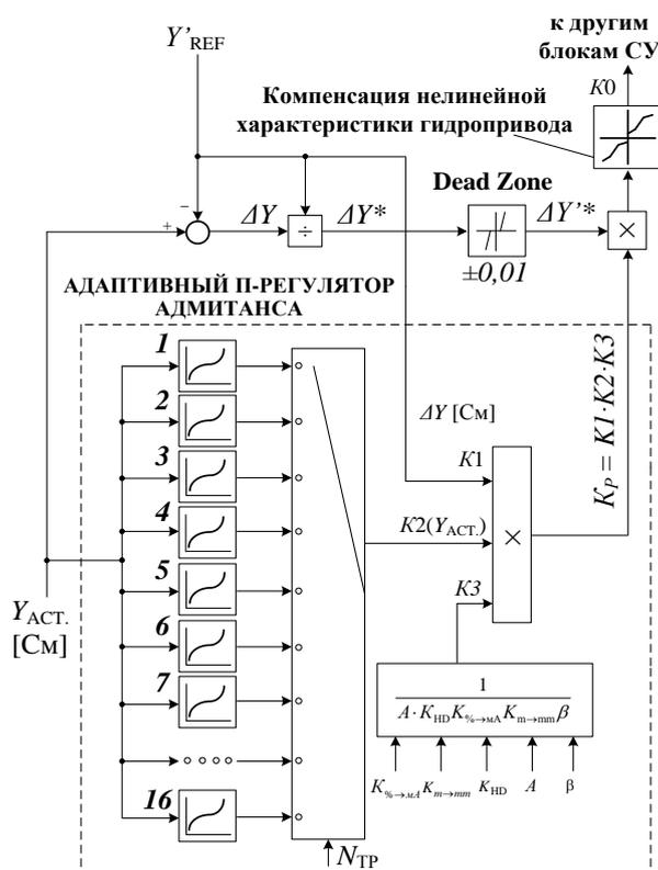
**Рисунок 7. Структурная схема усовершенствованного адаптивного регулятора адмитанса ДСП-250**
