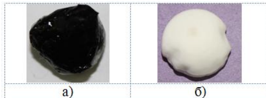
Рисунок 1 Вид таблеток, полученных в результате модификации силикагеля черным активированным углем (а) и белым углем (б)
