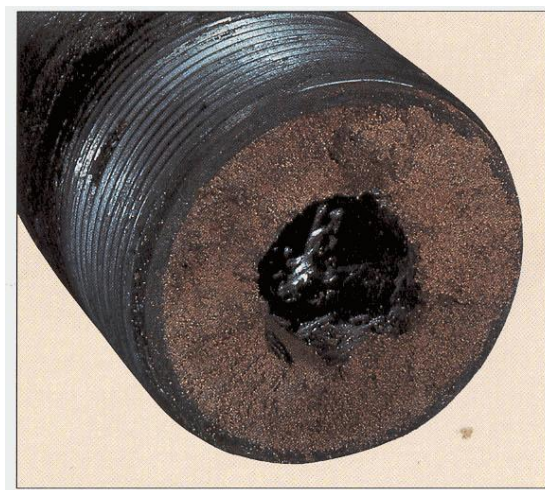
Рисунок 1. Асфальтосмолопарафиновые отложения в НКТ
