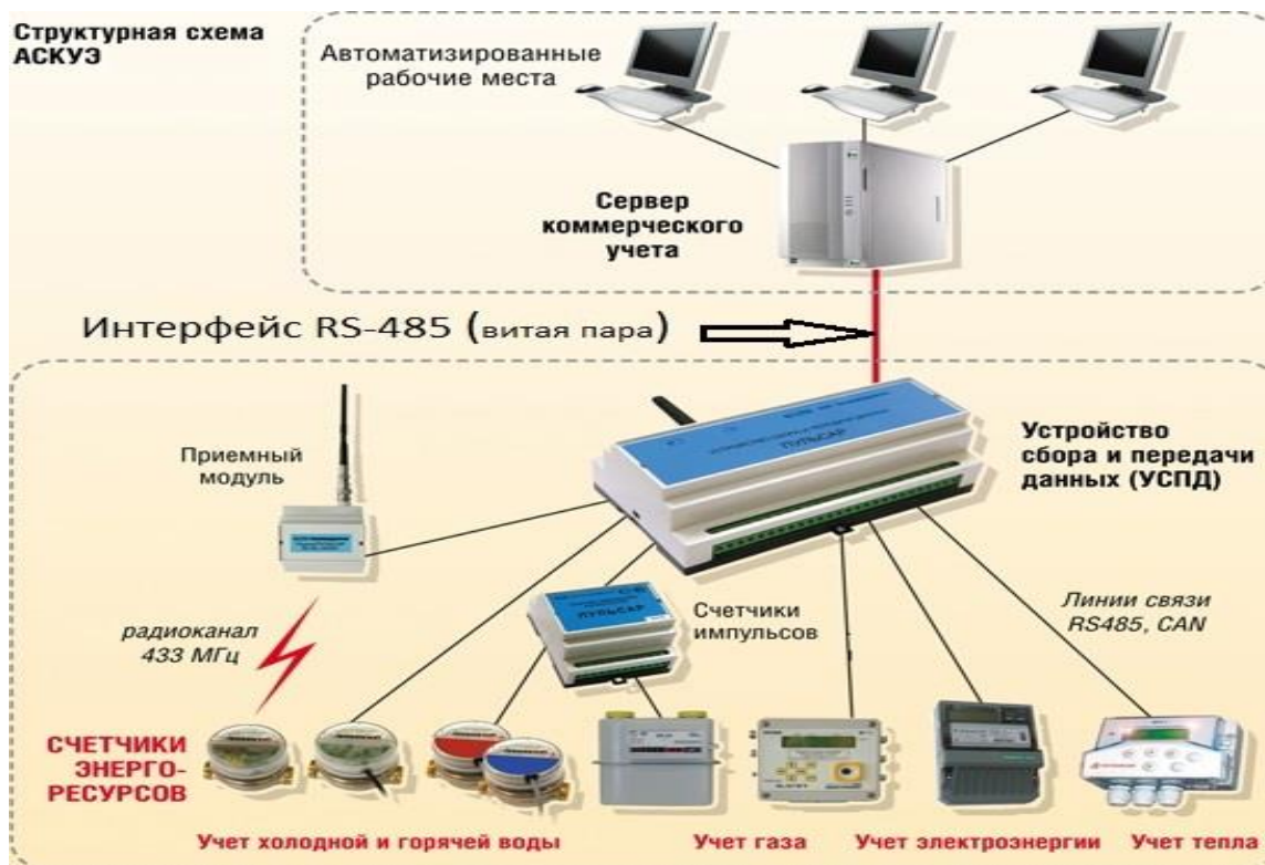
Рисунок 2. структурная схема АСКУЭ работающая на интерфейсе RS-485
