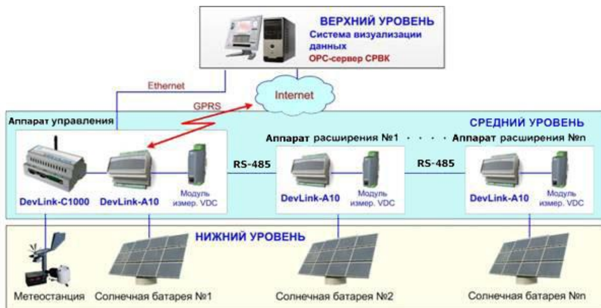
Рисунок 1. Системы автоматического управления трекерами солнечных батарей
