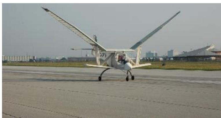
Рисунок 17. Моторный махолет UTIAS Ornithopter № 1
