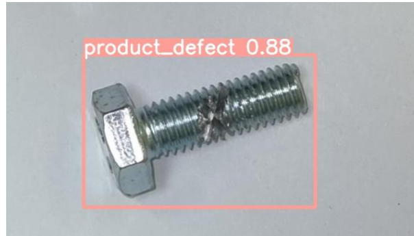
Рисунок 6. Работа нейронной сети yolov8l, класс “product_defect”
