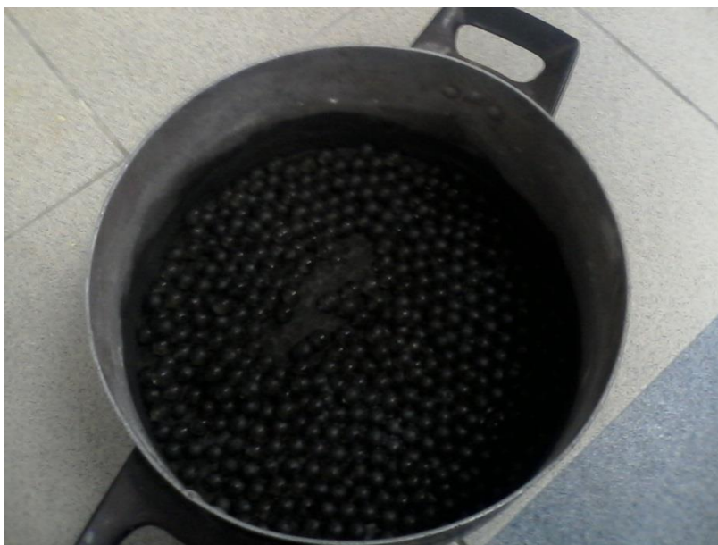
Рисунок 2. Образование гранул на шламе после обезвоживания
