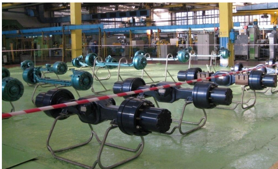
Рисунок 2. Ведущие мосты транспортных средств с центральным редуктором
