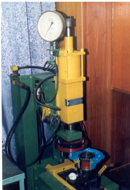
Рисунок 6. Опытно-экспериментальная установка для измерения требуемого размера компенсатора в подшипниковом узле ведущей шестерни редуктора среднего моста автомобиля «Камаз-5320»
