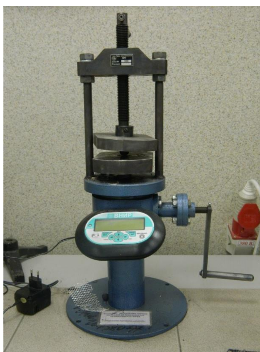
Рисунок 3. Установка для определения прочности на сжатие
