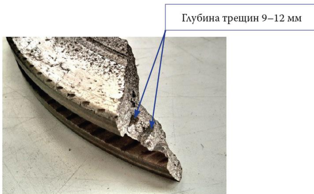
Рисунок 1. Трещины в рабочей поверхности калибра валка из чугуна СПХН-60 для прокатки арматуры № 12
