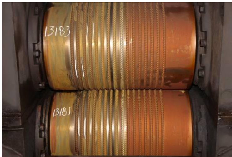
Рисунок 3. Чугунные валки СШХНФМ-60 для чистовых клетей стана 250-1
