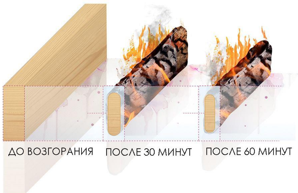
Рисунок 2. Деревянные конструкции под воздействием горения
