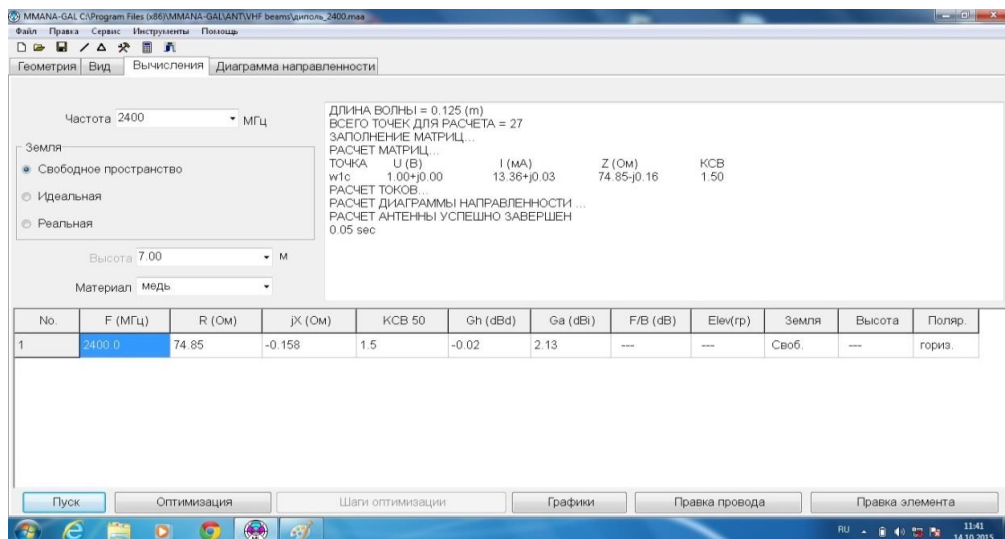
Рисунок 3. Расчёт параметров антенны типа «Диполь» в программе Mmana
