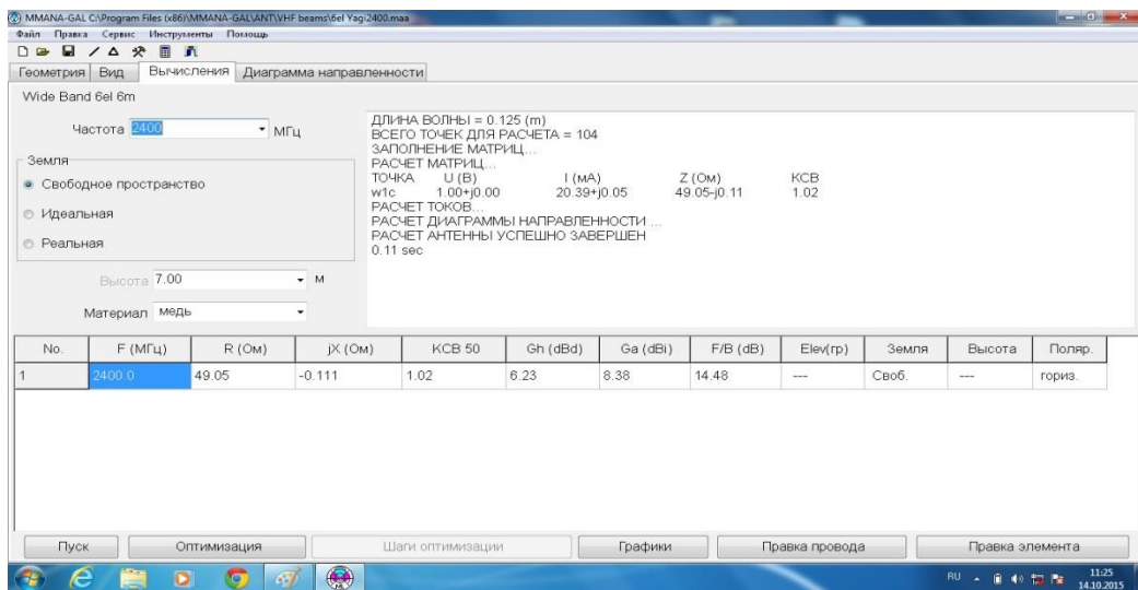
Рисунок 9. Расчёт параметров 6-и элементной антенны типа «Волновой канал» в программе Mmana
