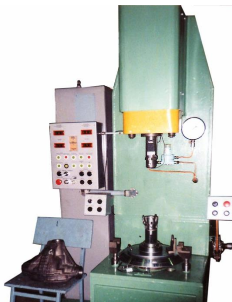
Рисунок 5 Стенд для измерения компенсатора при регулировании преднатяга на ОАО «ГАЗ»
