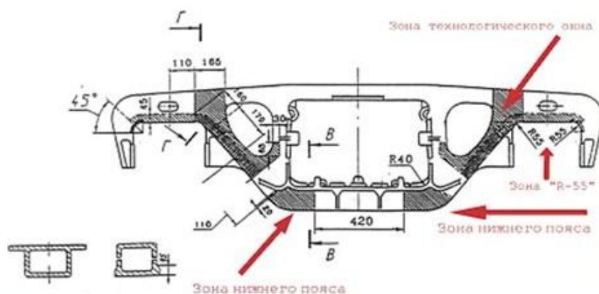
Рисунок 4. Боковая рама, зоны возможного возникновения дефектов
