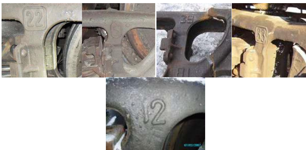
Рисунок 3. Клейма заводов-изготовителей, допустивших дефекты при изготовлении литья
