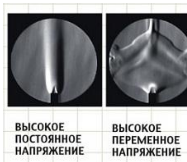
Рисунок 2. Поведение пламени при воздействии напряжением на электродах
