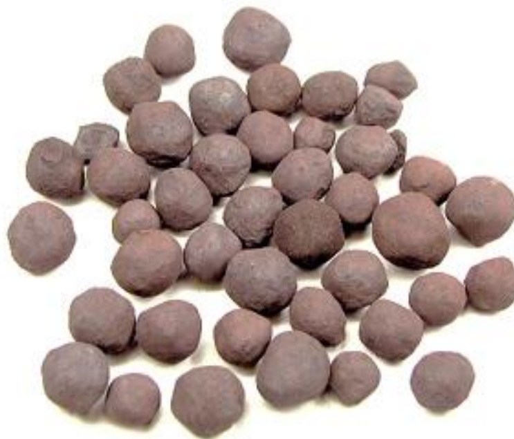
Рисунок 1. Железорудные неофлюсованные окатыши
