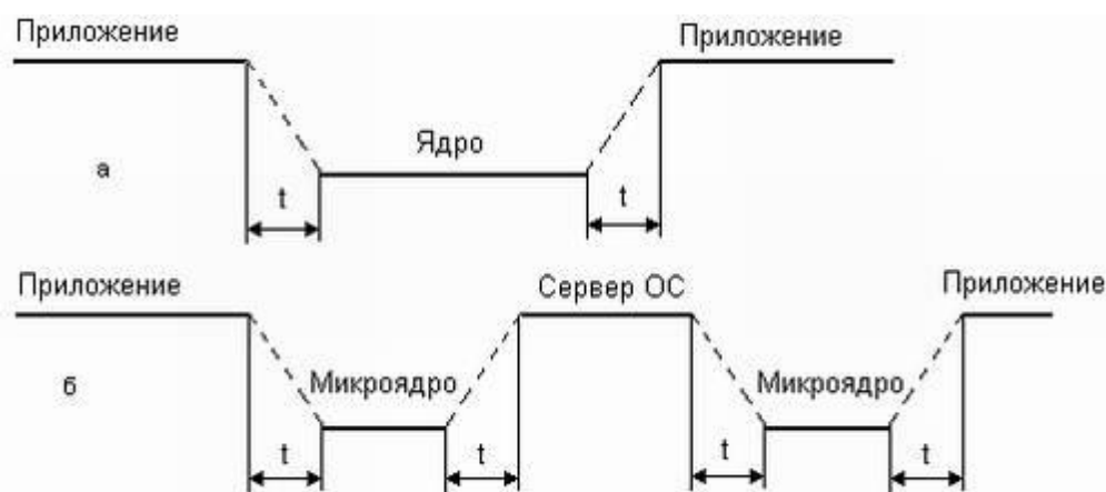
Рисунок 2. Смена режимов при выполнении системного вызова
