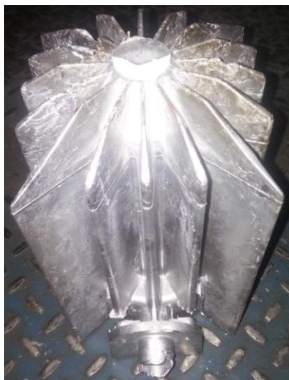
*Рисунок 1. Не полностью оформленная металлом отливка*
