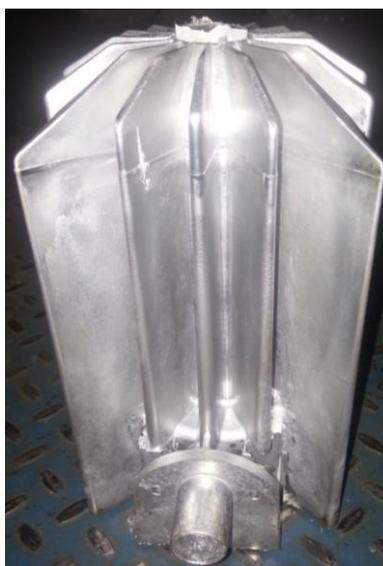
**Рисунок 7. Полностью оформленная отливка**
