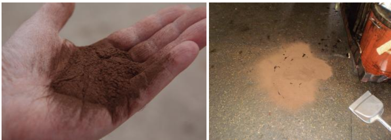
Рисунок 1. Нефтяной сорбент «SynergySorb®» ПС-150: внешний вид (слева), нанесение на место разлива (справа)
