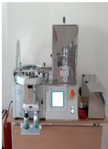
Рисунок 3. Машина для счета и фасовки капсул СРЕ-6
