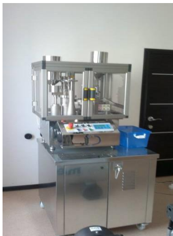
Рисунок 2. Автоматическая машина по наполнению капсул IN – CAP
