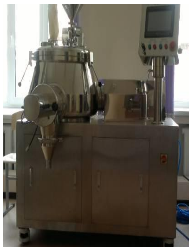
Рисунок 4. Высокоскоростной миксер, гранулятор, смеситель KSM – 50
