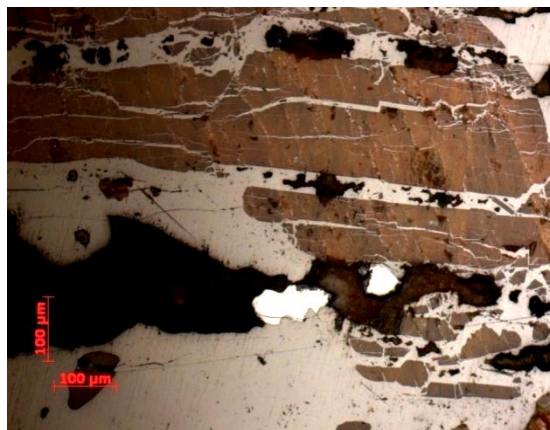
Рисунок 2. Полированный шлиф. В центре заметны бесформенные ярко белые выделения зерен золота
