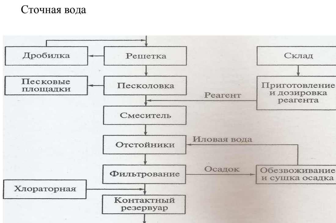
Рисунок 3. Технологическая схема очистной станции с механической и реагентной очисткой сточных вод коагулянтами (по Л.И. Цветковой и др., 1999)
