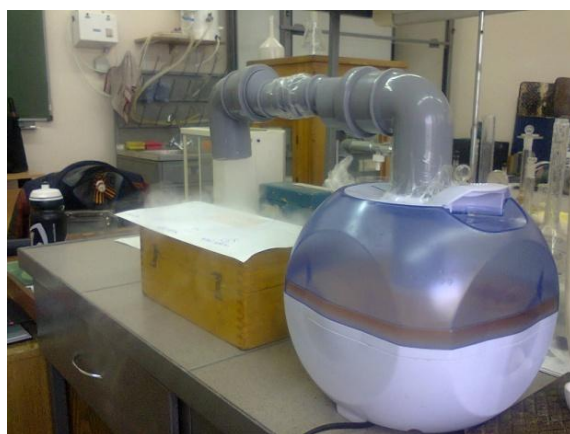
Рисунок 1. Ультразвуковой распылитель с направленным потоком
