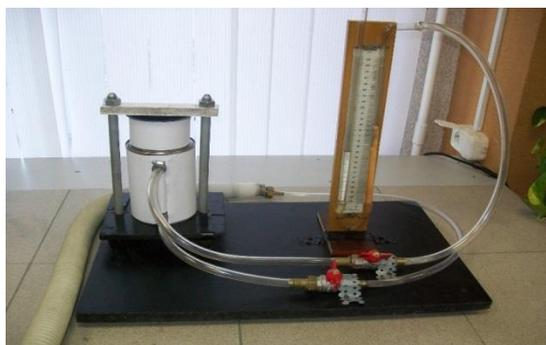
**Рисунок 1. Установка по определению реакционной способности металлизированного продукта**
