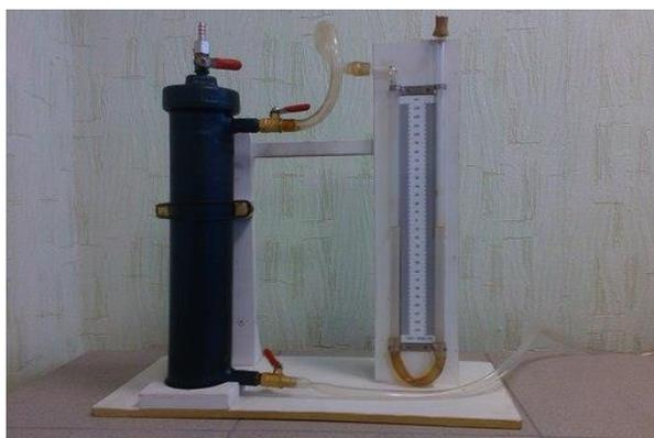
***Рисунок 2. Установка по определению реакционной способности металлизированного продукта***
