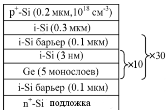
Рисунок 2. Схематическое изображение вертикального сечения исследуемого образца солнечного элемента 611 на основе Si с КТ Ge
