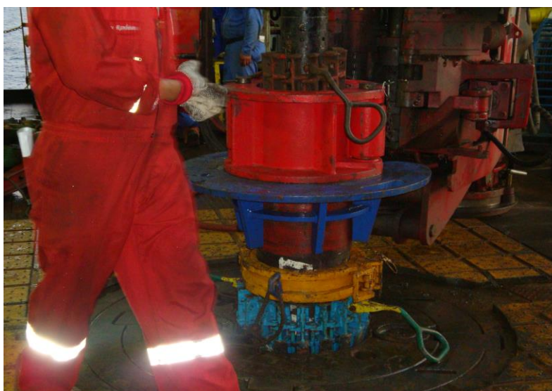
Рисунок 13. Извлечение КНБК через ОК с использованием бурового инструмента 127мм
