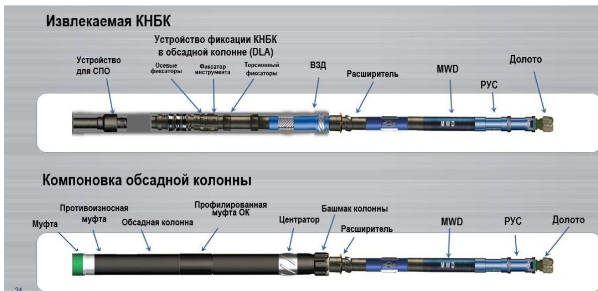
Рисунок 11. КНБК для бурения CWD L3
