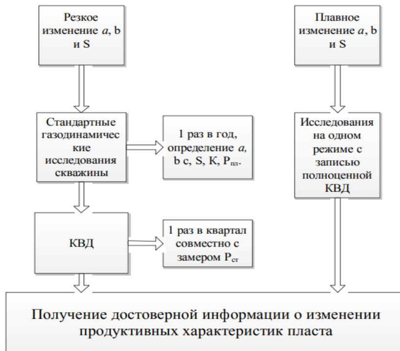
Рисунок 2. Алгоритм оптимизации количества исследований на газовых месторождениях
