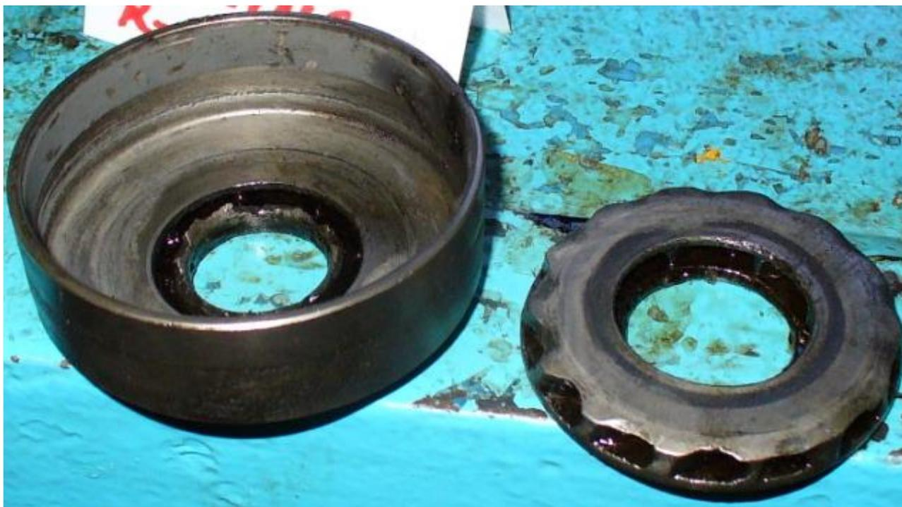
***Рисунок 2. Разрушение рабочих ступеней вследствие воздействия механических примесей***
