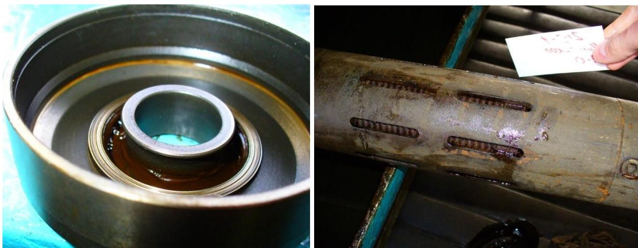
***Рисунок 4. Следы абразивного воздействия на поверхностях рабочих органов ЭЦН, оборудованного фильтром ФБР***
