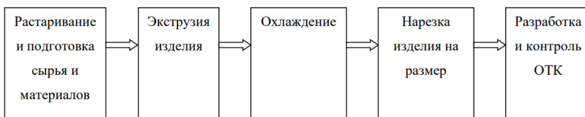
Рисунок 1. Алгоритм процесса изготовления профильно–огонажных изделий
